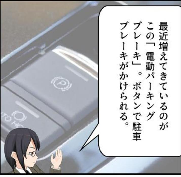
最近増えてきているのがこの「電動パークリングブレーキ」。ボタンで駐車ブレーキがかけられる。
